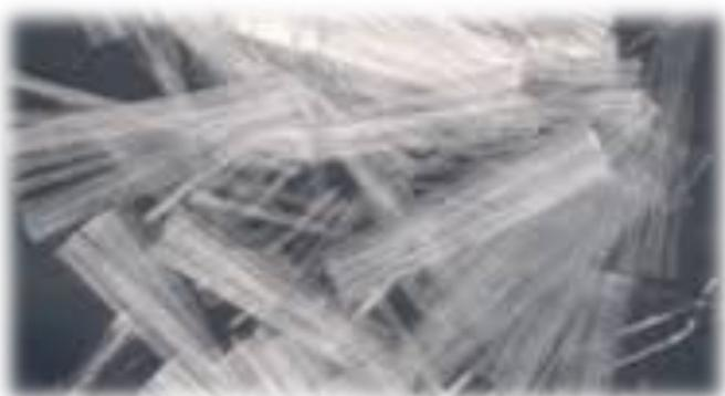
**FIBRES F 20MM** se présente sous la forme de fibres polypropylènes, blanches, en 20 mm conditionnées en poche pré-dosée pour faciliter un bon dosage et une bonne utilisation .
